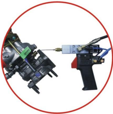
Dávkovanie oleja do tlakového kanála turbodýchadla
