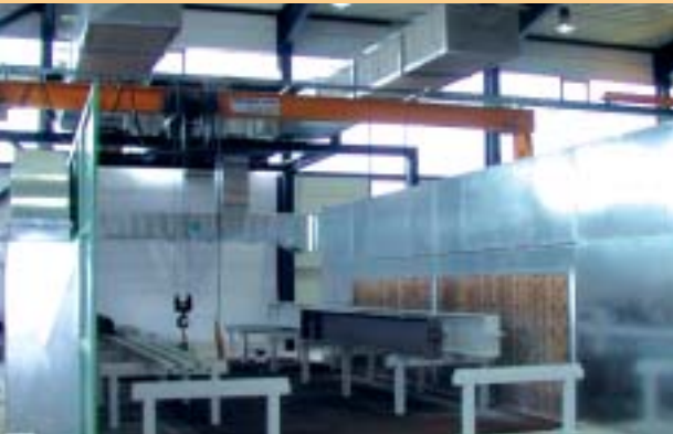
Offene Anlage mit seitlicher Absaugung für sperrige Teile
