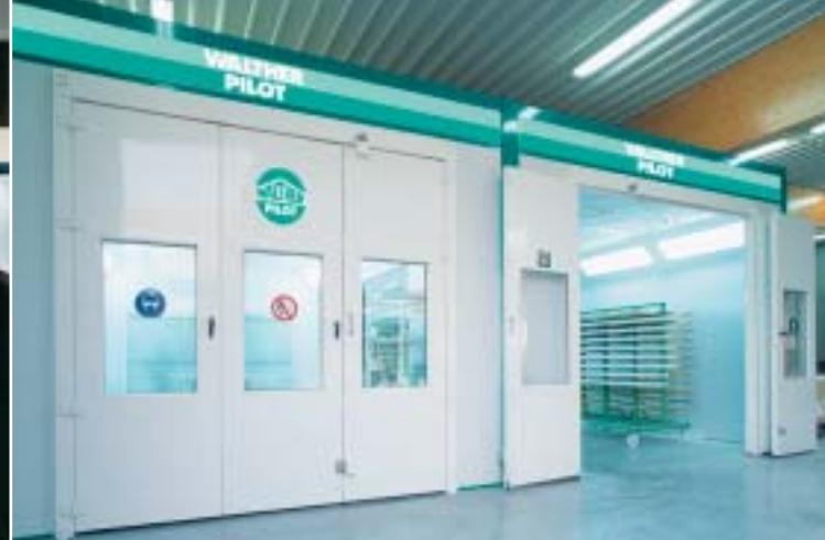
Dreiflügelige Eingangstür mit Fenstern aus Sicherheitsglas
