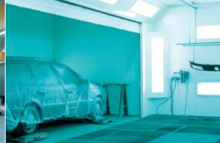
Sonderkabine mit seitlichem Rolltor und Fahrschienen
