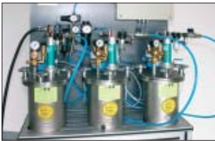
Druckbehälter-Farbversorgung für drei Markierpistolen
