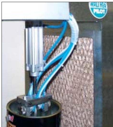
Kompakt-Spritzeinrichtung mit zwei Pistolen am Hubzylinder sowie Mehrschicht-Filtermatten
