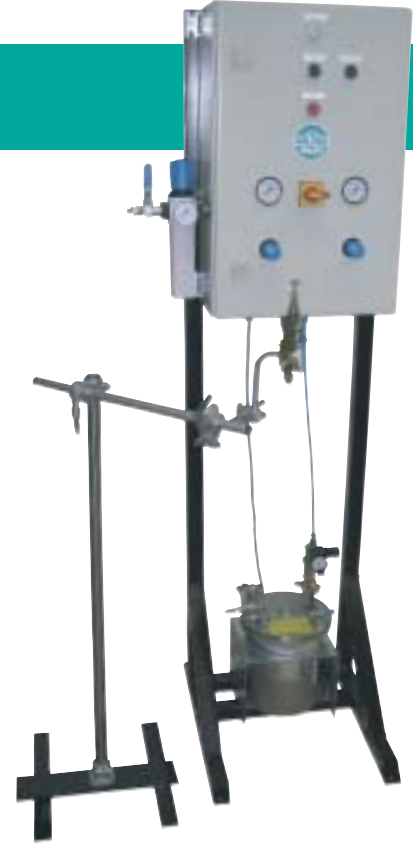
Markieranlage mit Schaltschrank auf Rahmen montiert, Druckbehälter mit Halterung und Signierautomat mit Befestigung.
