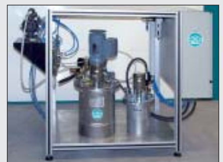
Kleinanlage für geringe Auftragsmengen mit Druckbehältern für Farbe und Lösemittel sowie Doppelmembranpumpe und Spülpistole.
