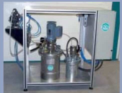
Kleinanlage für geringe Auftragsmengen mit Druckbehältern für Farbe und Lösemittel sowie Doppelmembranpumpe und Spülpistole.
