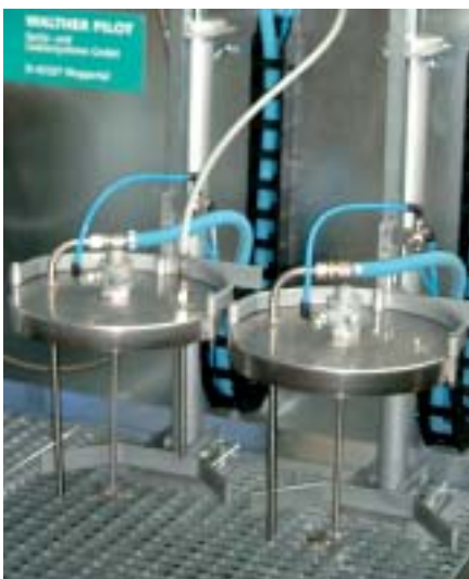
Eingebaute Heber mit Deckel und Druckluftrührwerk für 30-Liter-Gebinde
