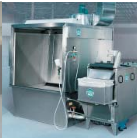
Wasserberieselte Anlagen mit Lackschlammaustrag
