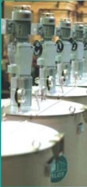
Farbmischbehälter versandfertig im WALTHER PILOT-Fertigungswerk Neunkirchen-Struthütten
