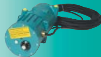
Materialerhitzer (3,5 kW) für den Einsatz bei Heißspritztechnik: Druckluftbereich: 0 - 450 bar. Zwei Ausführungen: • 230 V • 380 V
