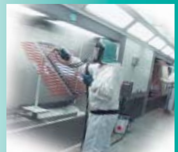
Anlage mit Naßabscheidung
