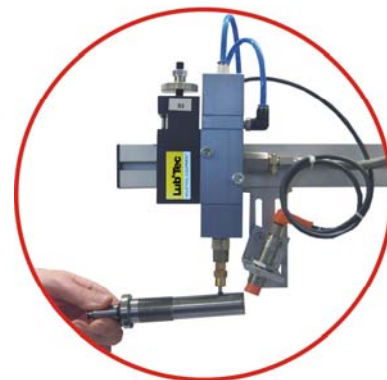
Celoživotní mazání ložisek vřetena pletacího stroje
