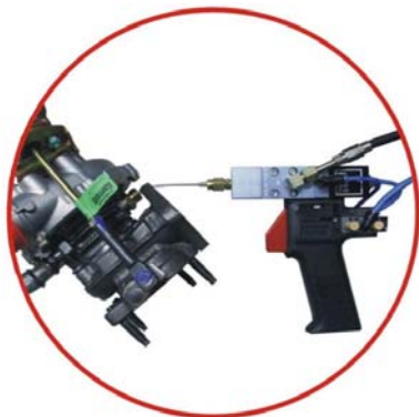
Dávkování oleje do tlakového kanálu turbodmychadla
