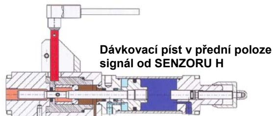
Pneumatický píst v přední poloze žádný signál od SENZORU P
